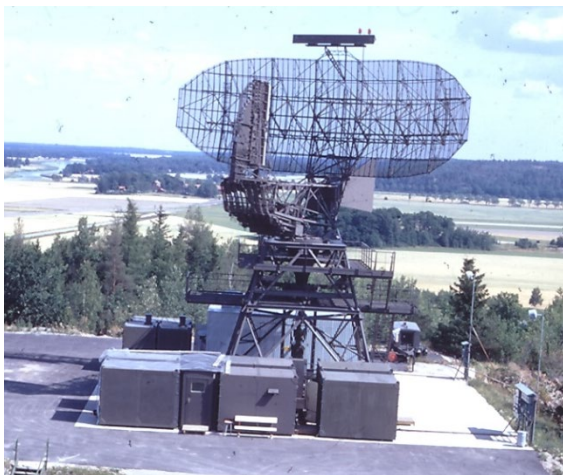
Radarstation PS-66 installerad på provplats Funny i Arboga. Antennarbete
